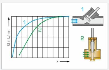
Características de las aberturas de la robinetería de cierre: Q caudal, x abertura, 1 válvula de asiento inclinado. 2 válvula de compuerta
