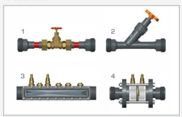
Robinetería de cierre y dispositivos deprimógenos para determinar el caudal; 1 válvula de compuerta, 2 válvula de asiento inclinado, 3 tubo de Venturi, 4 caudalímetro de placa con orificio o tobera de medida
