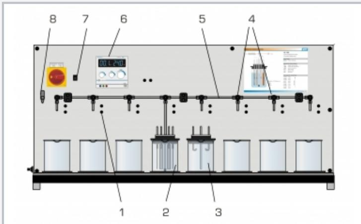
1 elektrische Anschlussbuchsen, 2 Elektrolytbehälter mit Proben und Probenhaltern (Klemmen), 3 Elektrolytbehälter mit Probenhaltern (Haken), 4 Drosselventile, 5 Gaszufuhr, 6 Netzgerät, 7 Schalter Membranpumpe, 8 Umschaltventil Luft / externe Gaszufuhr
