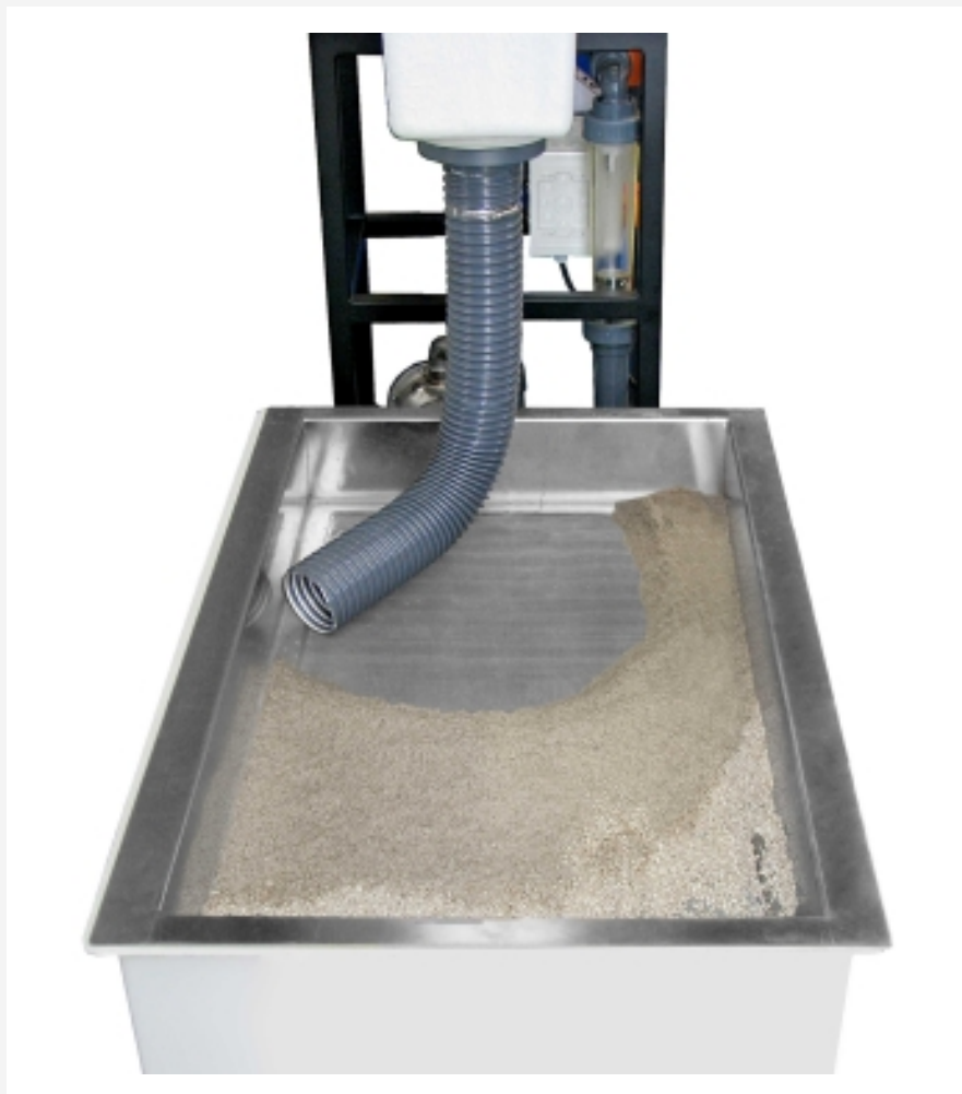
Trampa de sedimentos en el depósito bajo el elemento de salida de HM 160.
