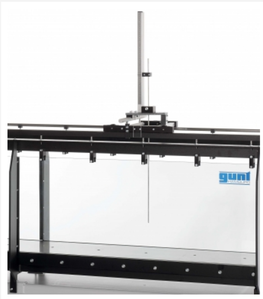
Die Abbildung zeigt HM 162.52 zusammen mit dem Instrumententräger HM 162.59.
