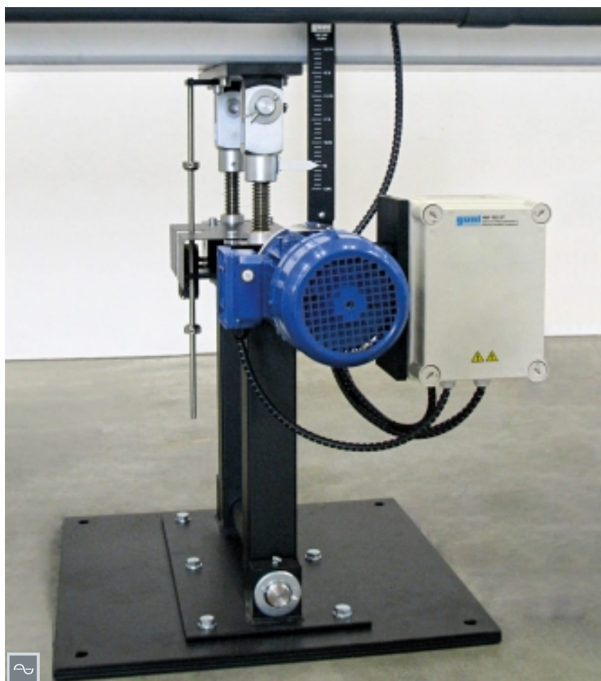
Die Abbildung zeigt die Hubstütze von HM 162 mit HM 162.57.
