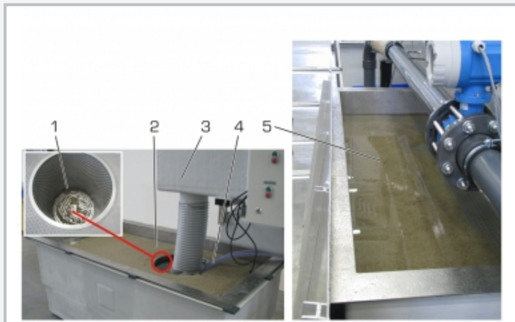
1 cesta de tamiz (bomba no representada), 2 sedimentos, 3 elemento de salida de HM 163, 4 sistema de tuberías para el transporte de la mezcla de agua y sedimentos, 5 tamiz para la eliminación de sedimentos en el segundo depósito de agua
