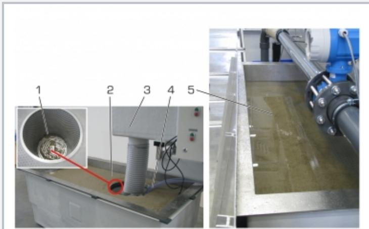
1 Siebkorb (Pumpe nicht dargestellt), 2 Sediment, 3 Ablaufelement von HM 163, 4 Leitungssystem zur Förderung des Wasser-Sediment-Gemischs, 5 Sieb zur Sedimententnahme auf 2. Wasserbehälter
