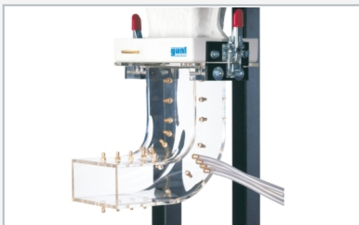
Étude de l'écoulement dans un raccord coudé à l'aide de l'accessoire HM 225.05
