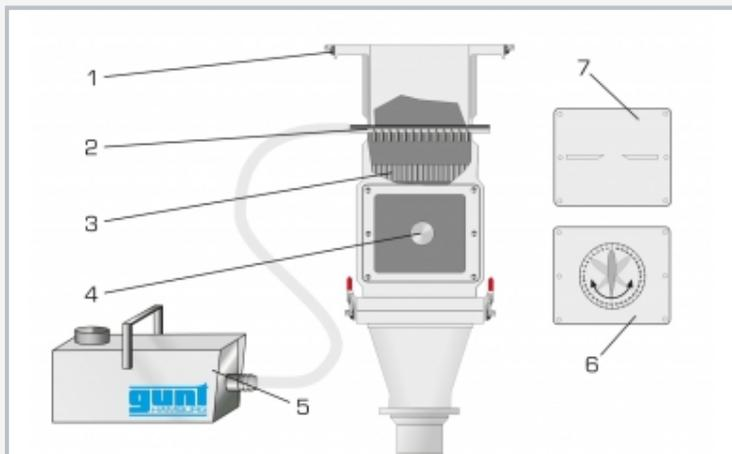
1 cierre rápido para conexión en HM 225, 2 distribuidor de niebla con toberas, 3 rectificador de flujo, 4 cilindro, 5 generador de niebla, 6 superficie sustentadora girable, 7 modelo placa con orificio
