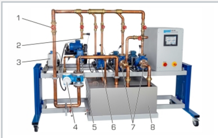
1 soupape d'étranglement (à la sortie), 2 raccordement pour pompe supplémentaire, 3 moteur pour la pompe supplémentaire, 4 capteur de débit, 5 pompe à piston, 6 pompe à canal latéral, 7 pompe centrifuge, 8 réservoir
