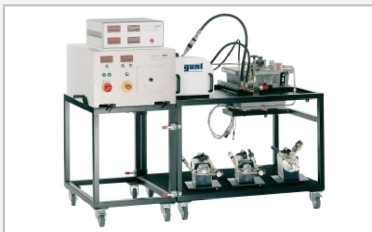
Montage expérimental fonctionnel: dispositif de freinage et d'entraînement universel HM 365 (à gauche), HM 365.20 avec pompe étudiée (à droite)
