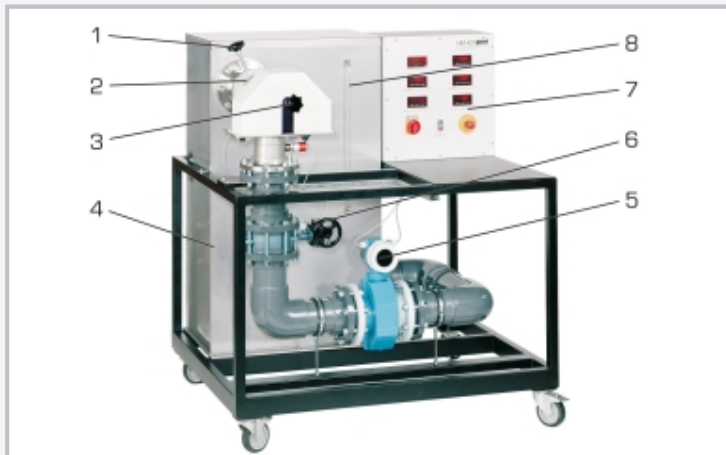
1 Hebel zur Einstellung der Leitschaufeln, 2 Propellerturbine, 3 Bremse, 4 Behälter mit Tauchpumpe, 5 Durchflussmesser, 6 Handrad für Drosselklappe, 7 Schaltschrank, 8 Füllstandsanzeige Behälter
