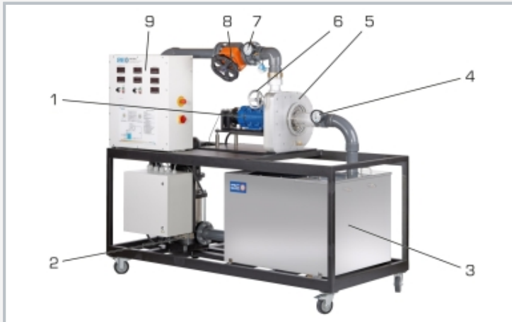
1 Asynchronmaschine, 2 Pumpe, 3 Behälter, 4 Anzeige für Druck am Turbinenaustritt, 5 Turbine, 6 Einstellung der Leitschaufeln, 7 Anzeige für Druck am Turbineneintritt, 8 Drosselventil, 9 Schaltschrank mit Anzeigen und Bedienelementen
