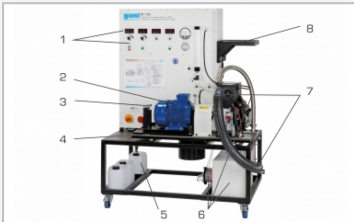
1 Anzeige- und Bedienelemente, 2 Asynchronmotor, 3 Kraftaufnehmer (Drehmoment), 4 Fundament, 5 Behälter für Kraftstoff mit Pumpe, 6 Beruhigungsbehälter mit Luftfilter und Luftschlauch, 7 Abgasanschluss, 8 Ablage, z.B. für CT 100.13
