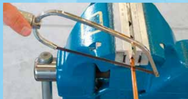
Länge des Rohrabschnittes bestimmen. Hierbei Zuschläge für Biegungen und Bördel berücksichtigen. Absägen des Rohres.
