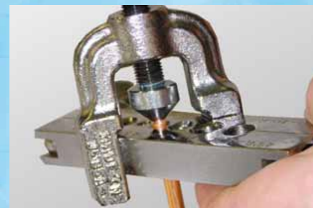
Bördeln des Rohres mit dem Bördelwerkzeug
