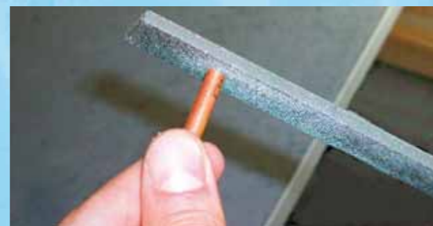
Glattfeilen des Sägeschnittes, Schnittfläche muss rechtwinklig zur Rohrachse liegen
