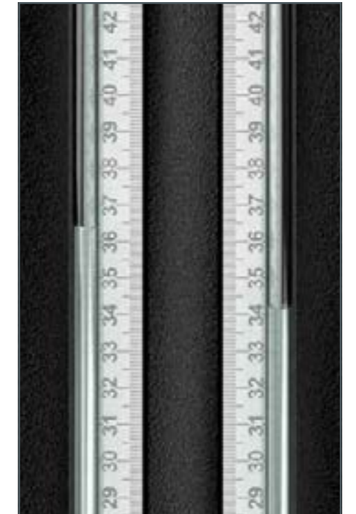
Le manomètre à tubes permet de déterminer de faibles pertes de charge avec une grande précision.
