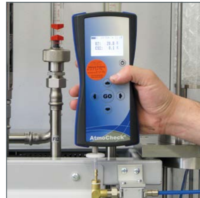
Gasanalysegerät zur Bestimmung des Sauerstoffgehaltes und Kohlendioxidgehaltes.
