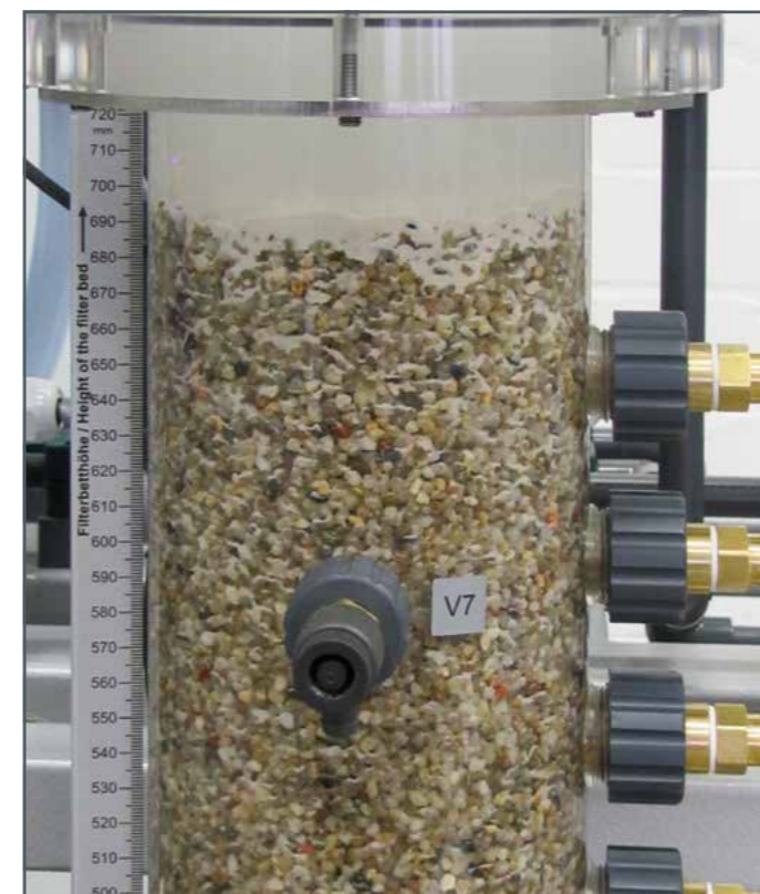
Transparentes Filterrohr zur Beobachtung der zunehmende Beladung des Filterbettes
