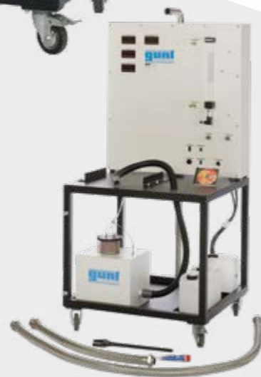
CT 159 Modularer Prüfstand für Einzylindermotoren, 3,0 kW
