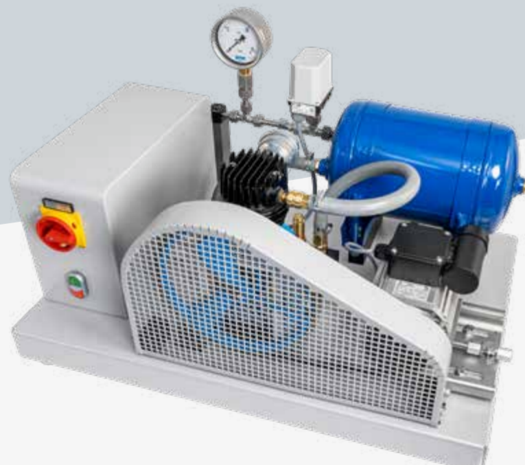
MT142 Energieeffizienz bei Kolbenverdichtern
