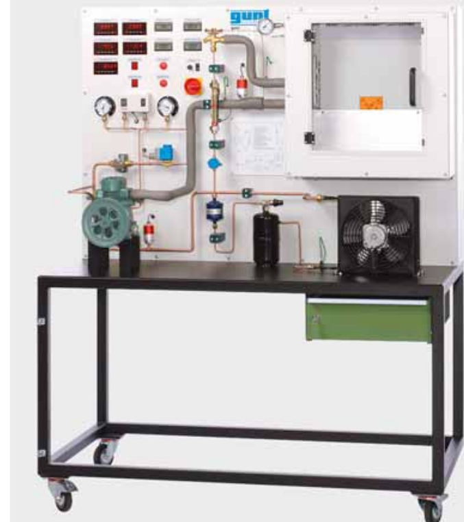
ET 165 Kälteanlage mit offenem Verdichter
