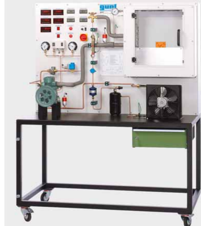
ET 165 Instalación frigorífica con compresor abierto
