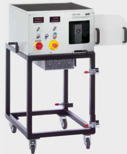
HM 365 Unidad universal de accionamiento y frenado
