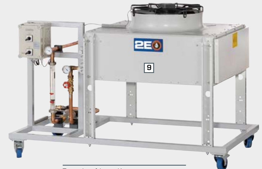
Torre de refrigeración en seco
