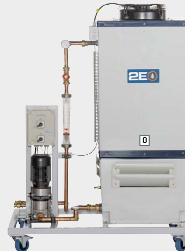
Torre de refrigeración por vía húmeda
