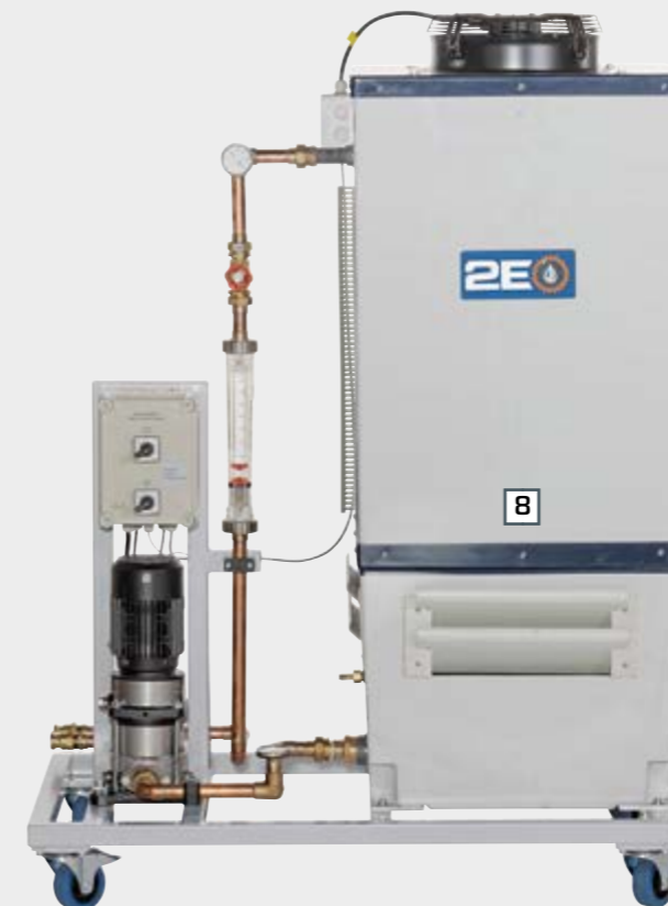
Torre de refrigeración por vía húmeda
