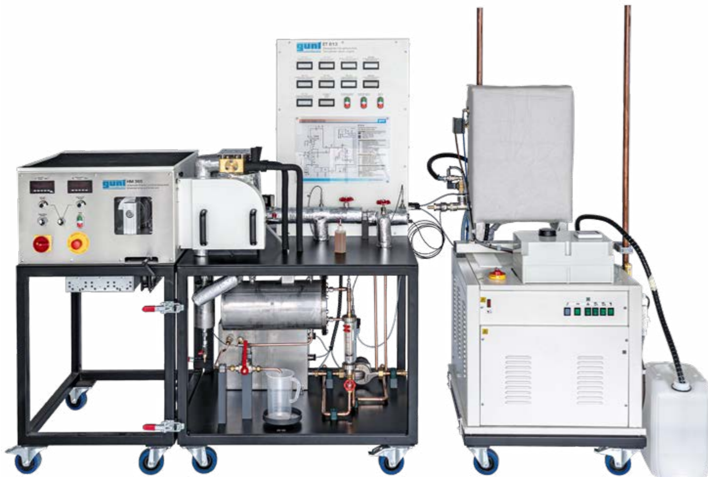
HM 365 Universale Brems- und Antriebseinheit
