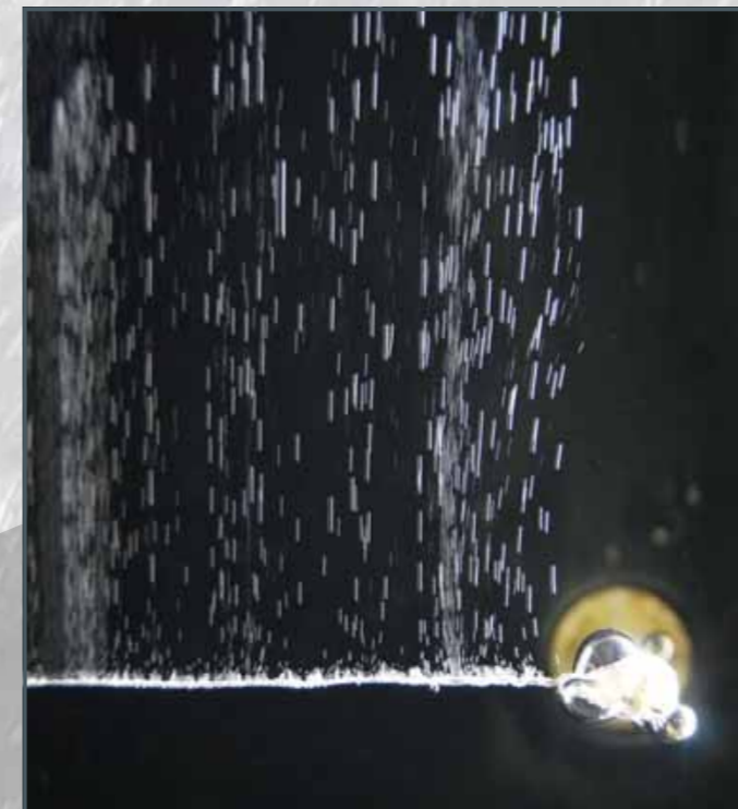
Elektrolytisch erzeugte Wasserstoffbläschen als Kontrastmittel.
