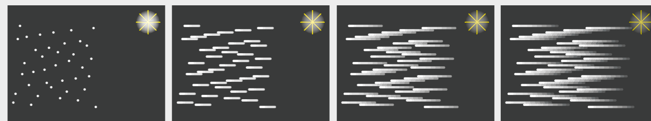
Belichtungszeit t_B Variabel. Beleuchtung Dimmen.
