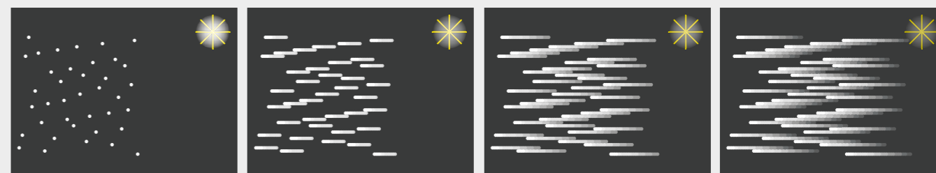
Tiempo de exposición t_E variable. Atenuación de la intensidad de la iluminación.
