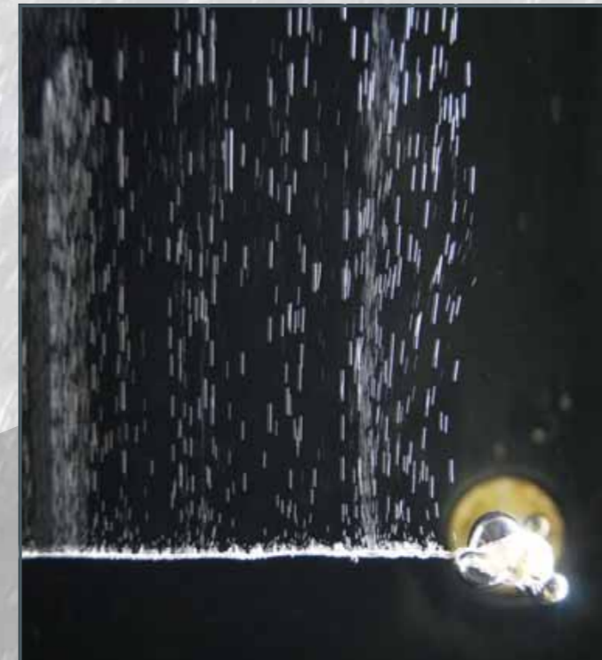
Burbujas de hidrógeno de generación electrolítica como medio de contraste.
