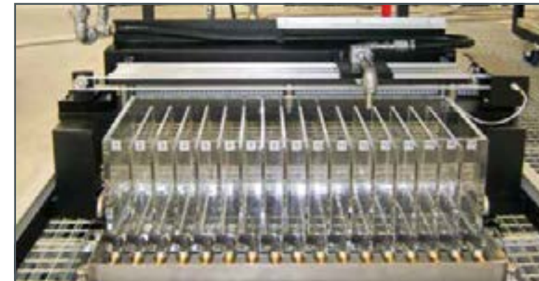
Die Messkammern werden zeitgesteuert nacheinander befüllt.
