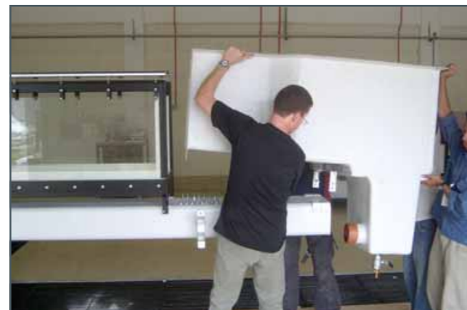
L'élément d'entrée est levé sur le support auxiliaire, aligné et relié à la section d'essai.
