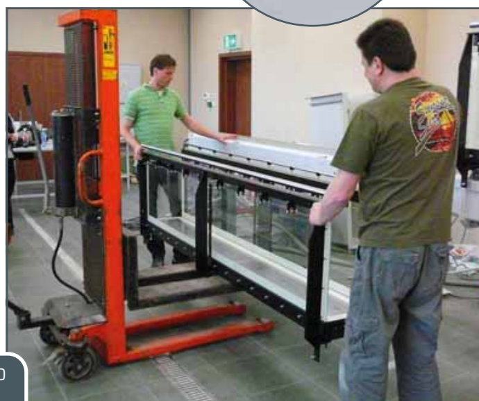
L'élément de la section d'essai est placé sur le support auxiliaire à l'aide d'un chariot élévateur à fourche, aligné puis monté.
