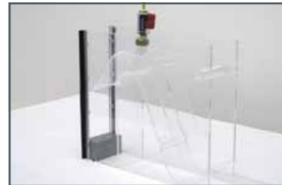
Déversoir à siphon HM160.36
