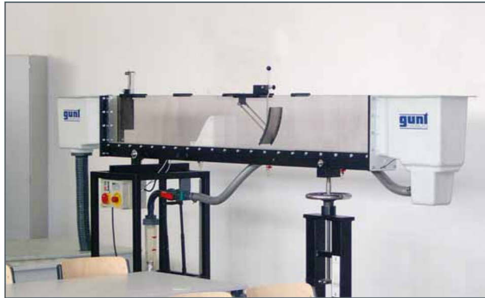
rundkroniges Wehr mit Druckmessung HM160.34
