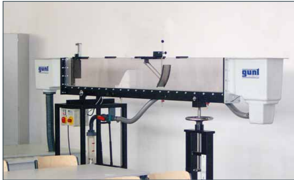
Presas-vertedero de perfil Ogee con medición de la presión HM160.34
