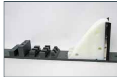
Presas-vertedero de perfil Ogee M160.32 y elementos para la disipación de energía HM160.35
