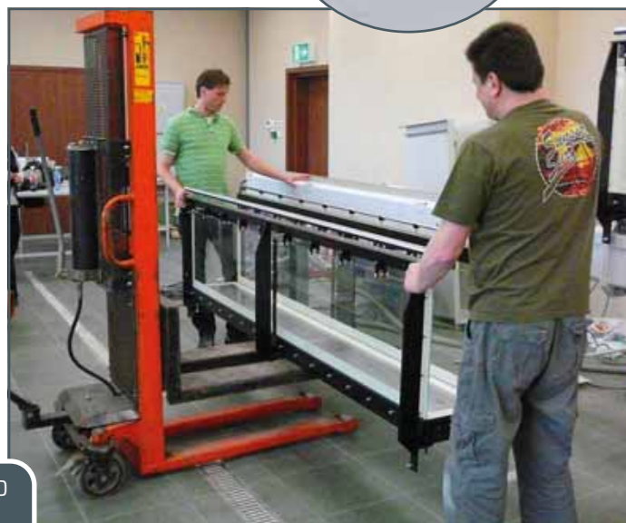
El elemento de la sección de ensayo es colocado sobre el elemento portador con una carretilla de horquilla elevadora, orientado y montado.
