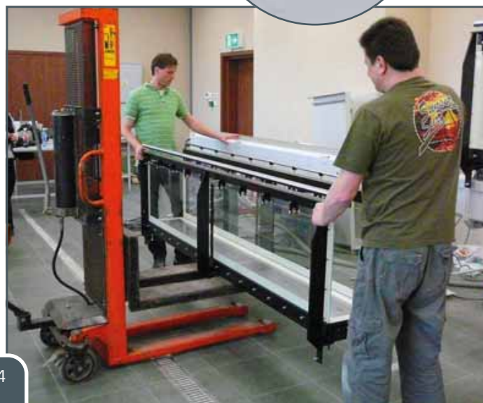
Das Element der Versuchsstrecke wird mit einem Gabelstapler etc. auf den Hilfsträger gesetzt, ausgerichtet und montiert.
