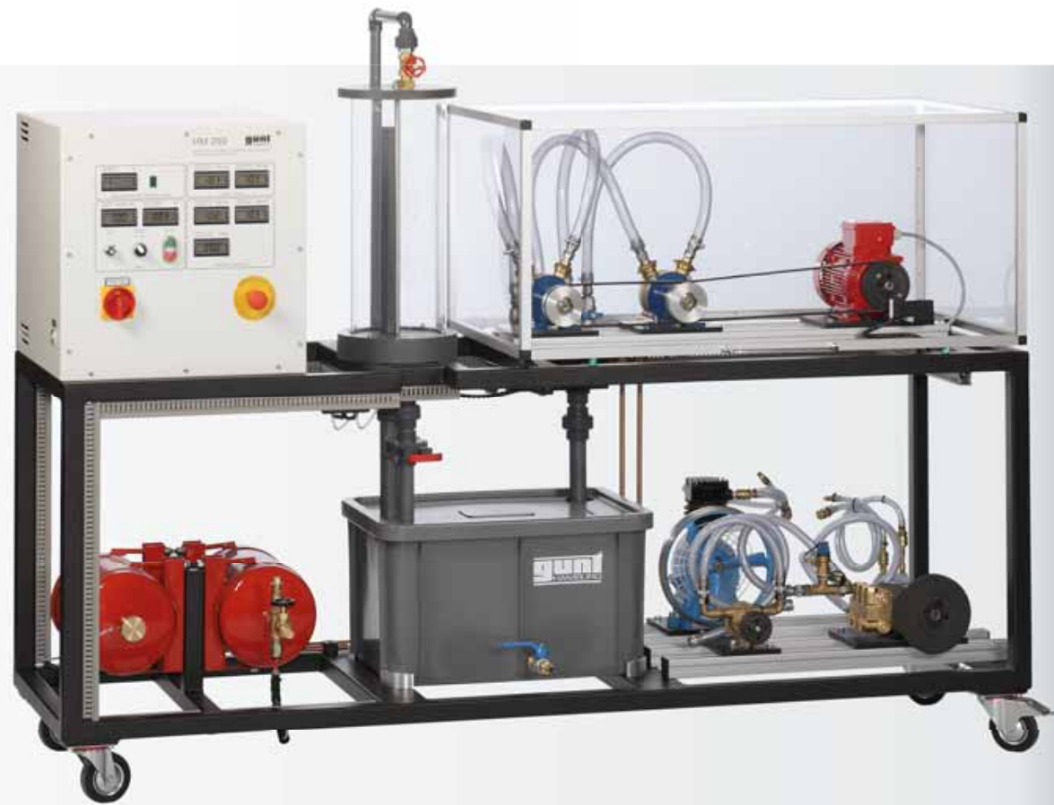
HM 299 Vergleich von Verdränger- und Strömungsarbeitsmaschinen: Die Abbildung zeigt den Versuchsstand mit zwei parallel angeschlossenen Kreiselpumpen.
