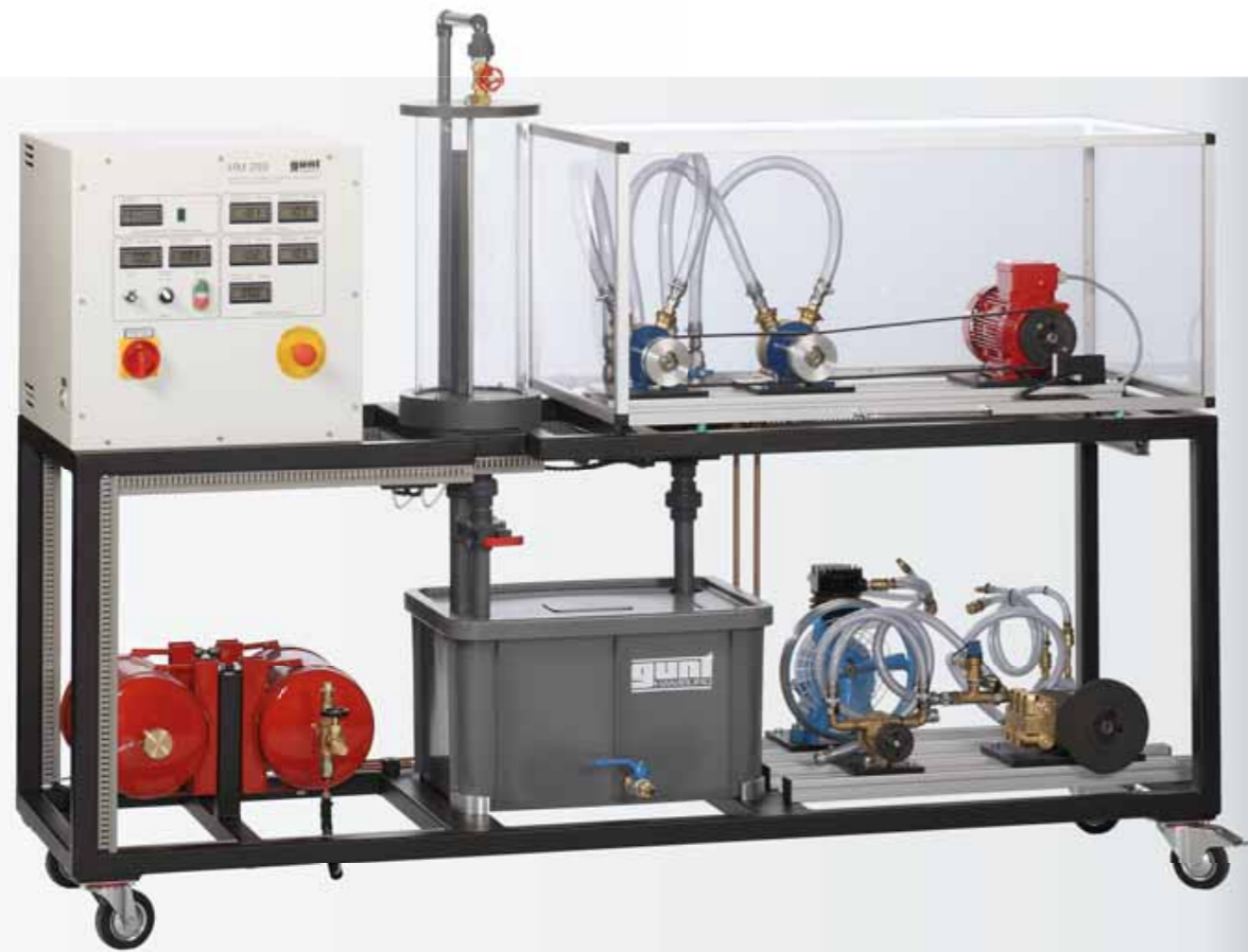
HM 299 Comparación de turbomáquinas generatrices y máquinas generatrices de desplazamiento positivo: La ilustración muestra el banco de ensayos con dos bombas centrífugas conectadas en paralelo
