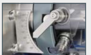
1 freno de corrientes parásitas, 2 ajuste de los álabes distribuidores, 3 álabes distribuidores, ajustables, 4 álabes móviles
