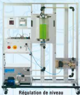
Régulation de niveau
