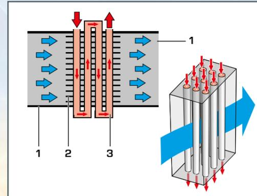
1 conduit d'air, 2 ailettes, 3 section de tuyau d'eau,
