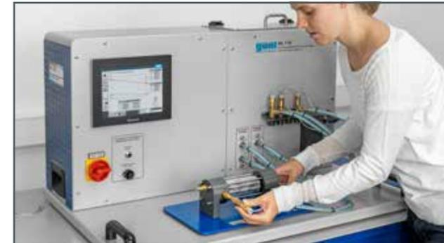
1. Déposer les raccords de tuyaux sur l'échangeur de chaleur à faisceau tubulaire.
