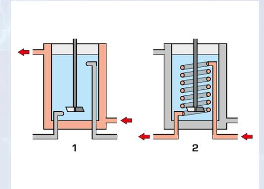
1 chauffage via l'enveloppe, 2 chauffage via le serpentin
