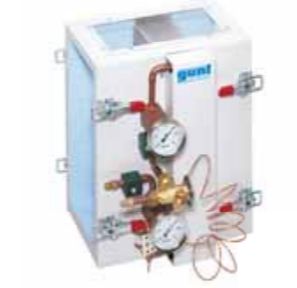
WL 312.03 Wärmeübertragung am Kältemittelverdampfer
