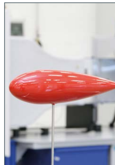
Medición de fuerzas de sustentación y resistencia aerodinámica en el cuerpo de líneas de corriente con el sensor de fuerza de dos componentes
