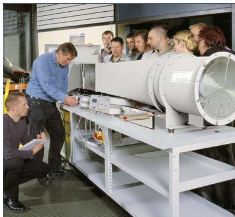
Curso de formación en el túnel de viento abierto HM 170 en la Escuela Técnica de Ingeniería Aeronáutica de Hamburgo (Alemania)
