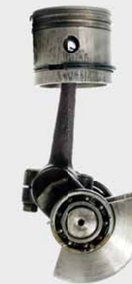
Exemple de forces oscillantes et rotatives dues à la masse: le piston alternatif
