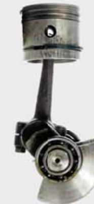
Oszillierende und rotierende Massenkräfte am Beispiel eines Hubkolbens
