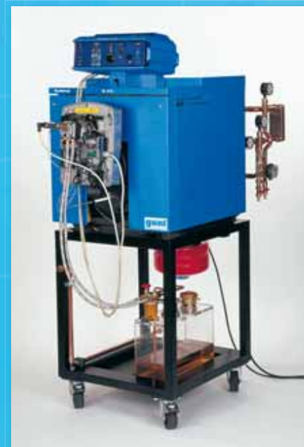
HL 351 Demo-Anlage Heizkessel
