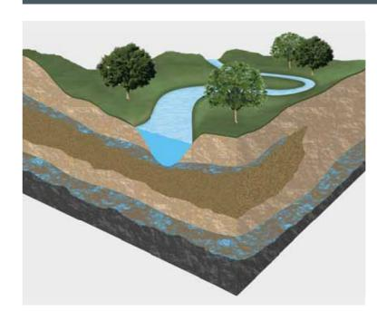
Les écoulements avec des matières perméables et les écoulements souterrains sont des mouvements de l'eau dans un sous-sol perméable (sable, gravier, etc.). L'infiltration et le stockage des précipitations en font partie. En génie hydraulique, l'infiltration des digues en terre ou l'infiltration des ouvrages de retenue ont une importance particulière.
