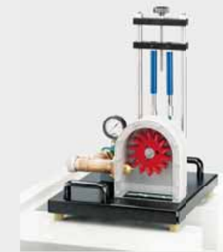
HM 150.19 Funktionsprinzip einer Peltonturbine
