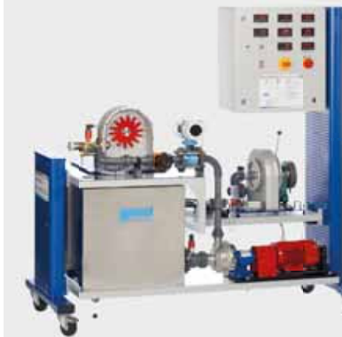
HM 450C Kenngrößen hydraulischer Strömungsmaschinen, zusammen mit der Peltonturbine HM 450.01 und der Francis turbine HM 450.02
