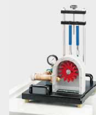
HM 150.19 Principio de funcionamiento de una turbina Pelton
