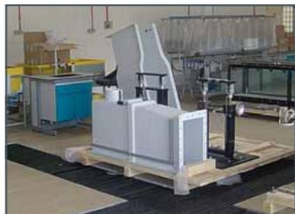
Elemento de entrada, elemento de salida y soportes de canal
