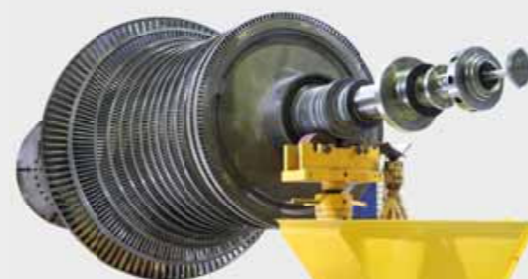
Laufrad einer Dampfturbine im ausgebauten Zustand
